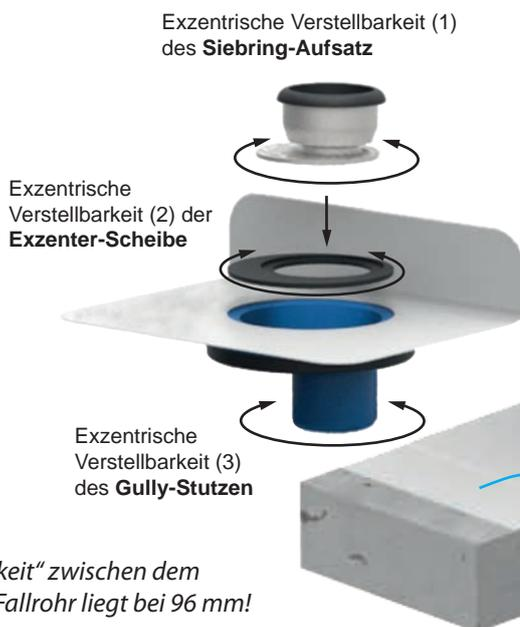
Die Maximale „exzentrische Verstellbarkeit“ zwischen dem ankommenden und dem abgehenden Fallrohr liegt bei 96 mm!
