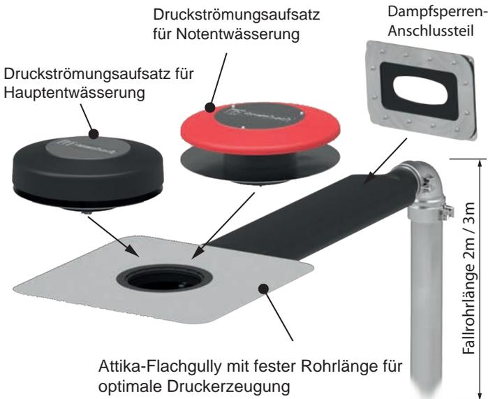
Grumbach Attika-Power-Drain für die Notentwässerung. Eingebaut im Warmdach mit optionaler Dampfsperrdurchführung und Druckströmungsfallrohr.
